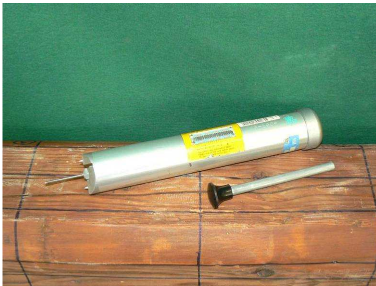
Obr. 2.: Přístroj na měření hloubky zarážení trnu do dřeva Pilodyn 6J.
