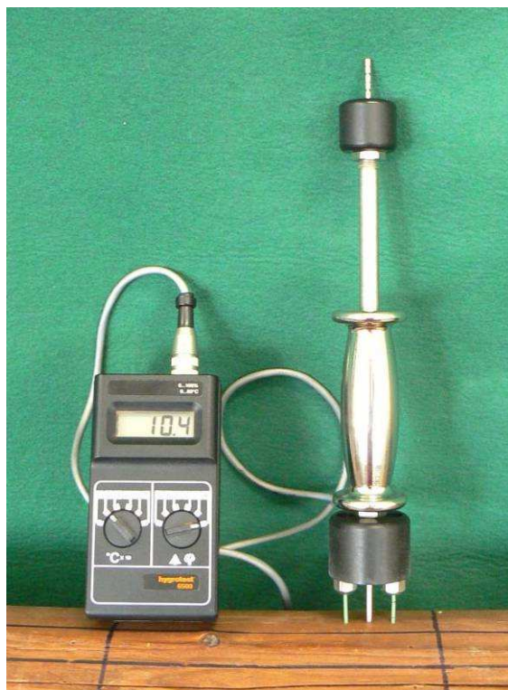
Obr. 1.: Přístroj na měření vlhkost dřeva Hygrotest 6500 se záražecí sondou.
